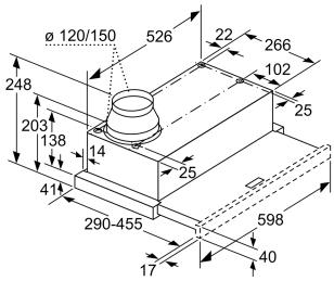
Tiefenanpassung des Filterauszuges bis 29 mm möglich
